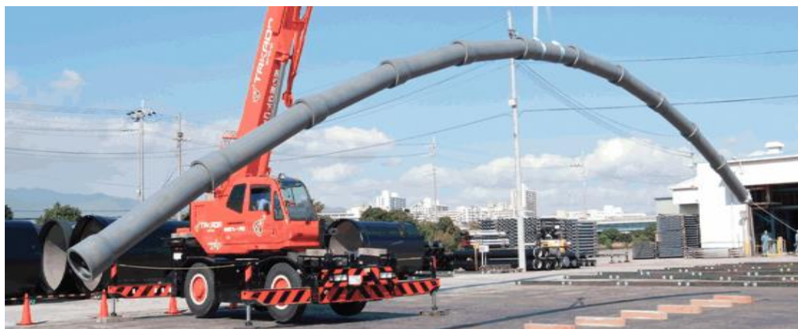
図 2-7 耐震継手型ダクトイル鋳鉄管
