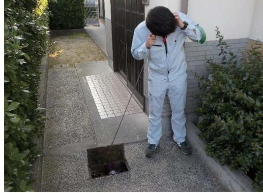
漏水調査(管路、給水装置)
