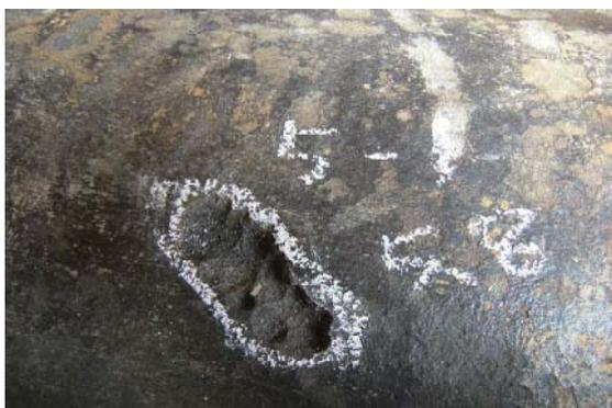
管体調査で明らかになった腐食の進んだ水道管(鑄鉄管)
