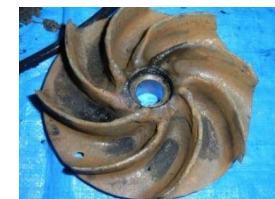
ポンプ羽根車のすり減り
