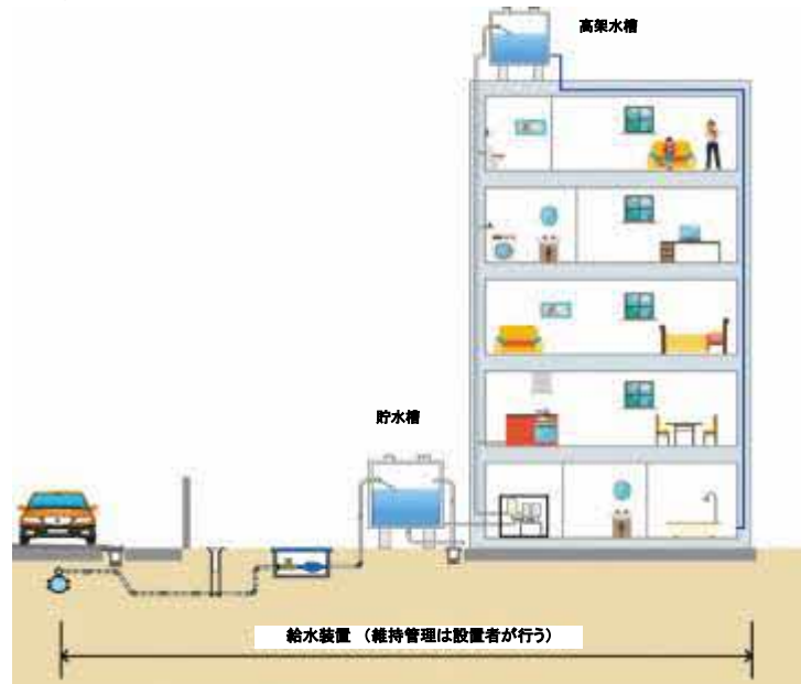
貯水槽水道による給水装置の模式図
